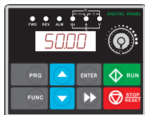
Stop status parameter display (Display set frequency "50.00")
