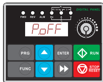
Power-on parameter display (Initialization display "P.OFF")
