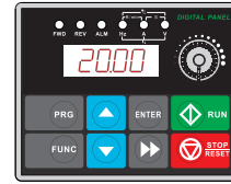
Run status parameter display (Display current output frequency "20.00")
